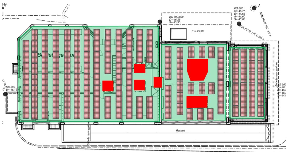
**Abbildung 2: Dachauslegung Betriebsgebäude, maximal 37.96 kWp installierte PV-Leistung**
