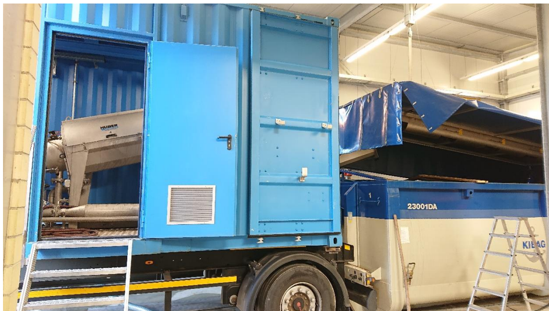
Abbildung 9: Mobile Schneckenpresse der Huber Picatech AG auf der ARA Gossau/Grüningen.
